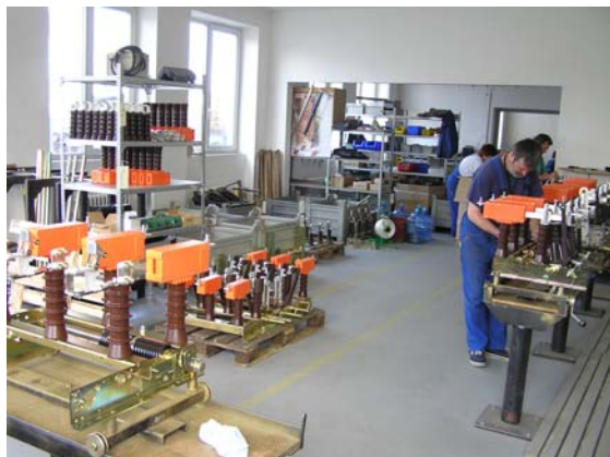
Dílny – montáž vnitřních přístrojů
