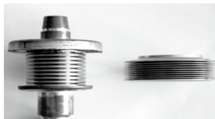
Srovnání ocelových manžet: složená ocelová manžeta TEL – typ svařovaný z jednotlivých disků.
